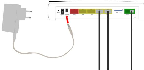
Schliessen Sie bitte den Inteno EG 400 Router an das Netzteil an. Danach das Netzteil an die Steckdose anschliessen, und das Gerät mittels "ON" Schalter auf der Rückseite des Routers einschalten. Die LED auf der Oberseite des Routers leuchtet nun.
