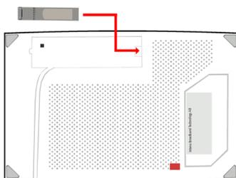
Stecken Sie den Skylane Adapter in den, im Inteno EG 400 Router enthaltene Anschluss.
