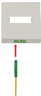
Stecken Sie danach das grüne Ende des Glasfaserkabels in den **Steckplatz 1** der Glasfasersteckdose (OTO-Dose).
